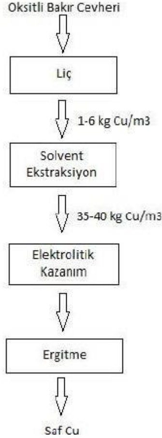
Şekil 1. Hidrometalurjik bakır (Cu) üretim diyagramı
