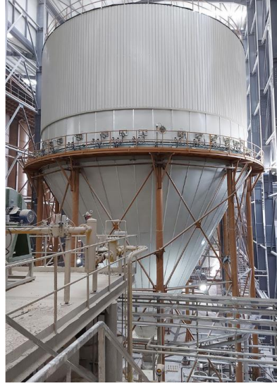
Şekil 2. Seramik karo üretiminde kullanılan endüstriyel püskürtmeli kurutucu [17].
