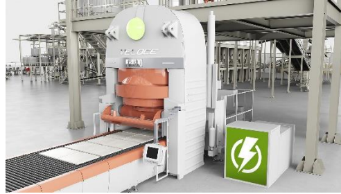
Şekil 3. Seramik karo şekillendirmede kullanılan endüstriyel hidrolik pres [19].
