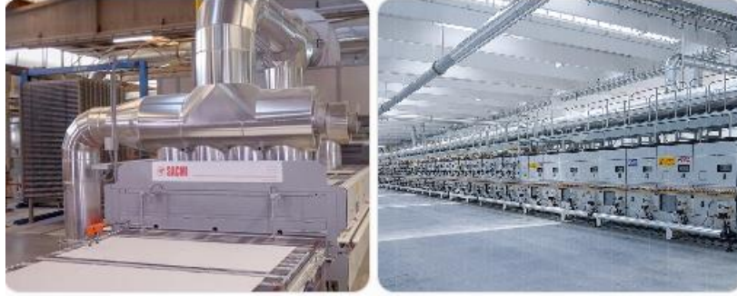
Şekil 4. Seramik karoların pişiriminde kullanılan endüstriyel roller fırın [21].
