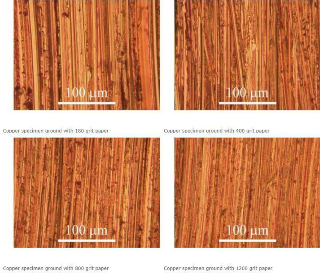
Şekil 6. Farklı grit numaralı kağıtlarla zımparalama yapılmış bakır yüzeyleri
